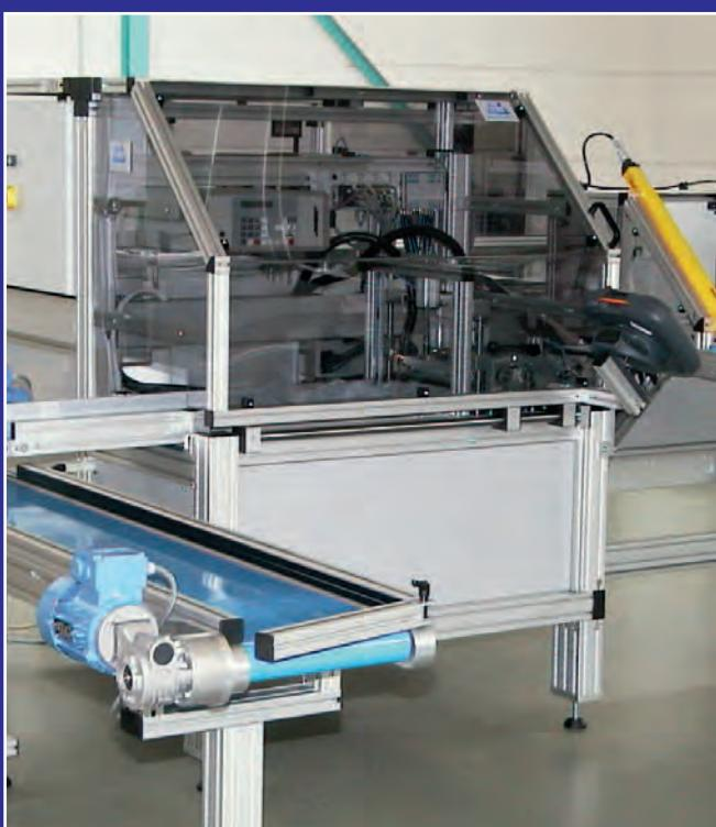
Der Folienverpackungsaomat Modell 300-FF/DE ist explizit für die definierte Befüllung/Bestückung von PE-Beuteln konzipiert.
