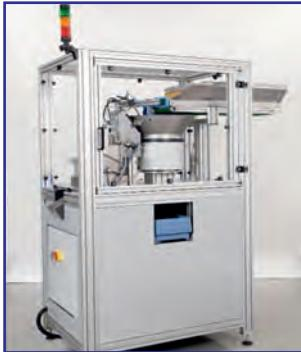
AVT - Zählautomaten werden im Bereich des reinen Zählens von Teilen eingesetzt. Im Verbund ergänzen sich mehrere Zählautomaten zum Herstellen von Produktassortimenten. Zum Einsatz kommen vornehmlich Wendelförderer mit und ohne Linearstrecke, sowie mit reinen
